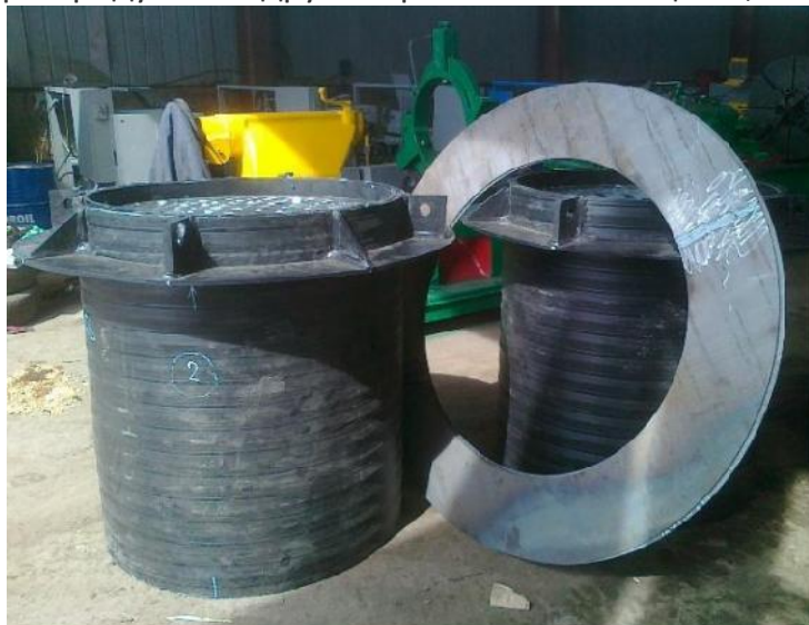
Фильтрующий патрон с опорным кольцом (сталь)
